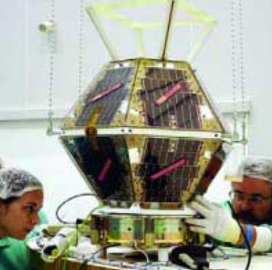
*Colocación del Modelo de Vuelo en la estructura auxiliar.*
