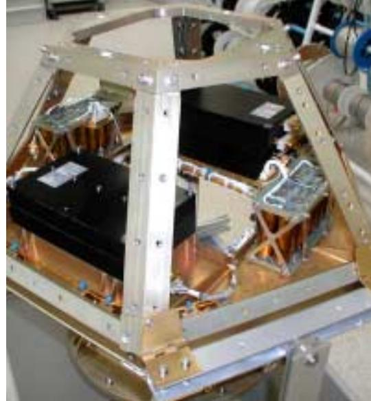
*El Modelo de Calificación e Ingeniería (EQM) desprovisto de los paneles, mostrando la disposición interna de parte de los equipos.*
